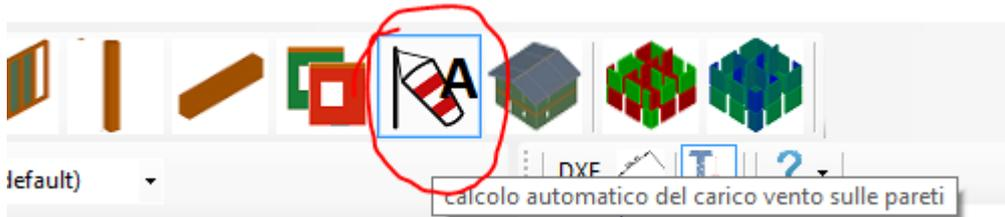
E' possibile visualizzare la **colormap dei coefficienti di forma  $c_p$**  attivando dalla toolbar della rappresentazione 3D la visualizzazione per *coeff.  $c_p$  vento* e selezionando dalla maschera dati a destra sia la condizione di carico vento che il tipo di coefficiente (vento agente direttamente sulla parete oppure sulle coperture a falde iniziale o finale):
